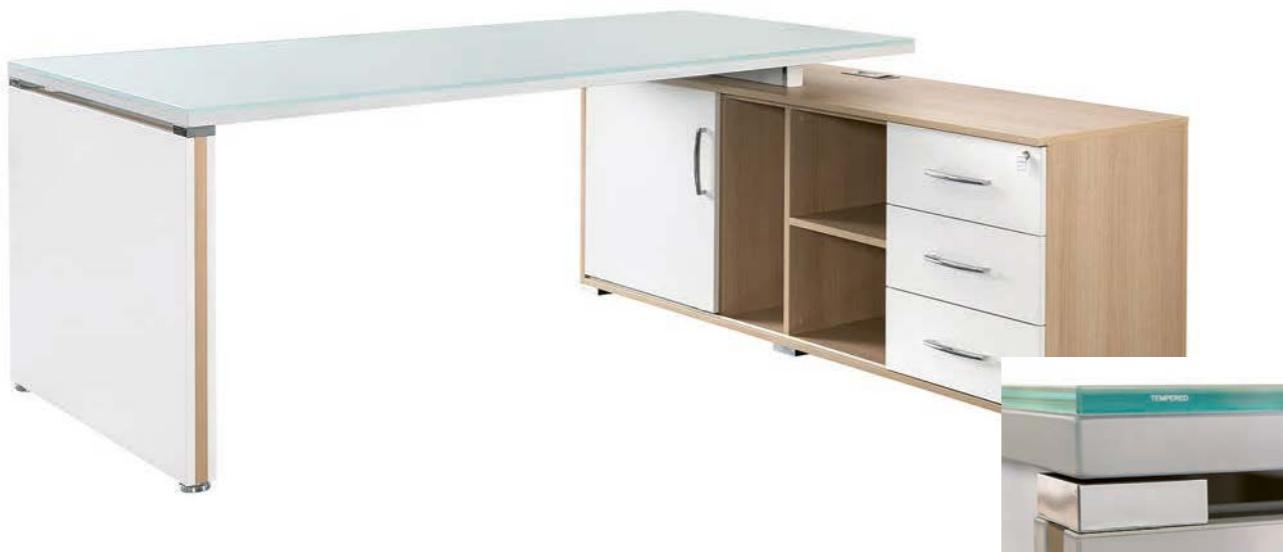
Столешницы столов имеют толщину 43 мм, состоят из 18 мм ДСП с накладками из 25 мм МДФ, облицованы по периметру ПВХ-кромкой толщиной 2 мм.
